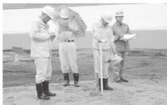
放射能汚染焼却灰埋設地点での線量測定
