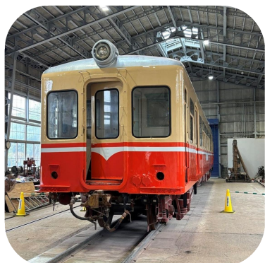
7月から塗裝修繕作業中のキハ2101
